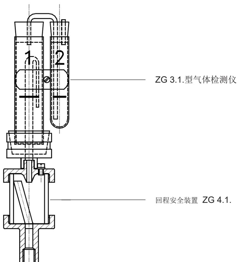
图 2 - 与 ZG 3.1.型气体检测仪连接的 ZG 4.1. 型回程安全装置
